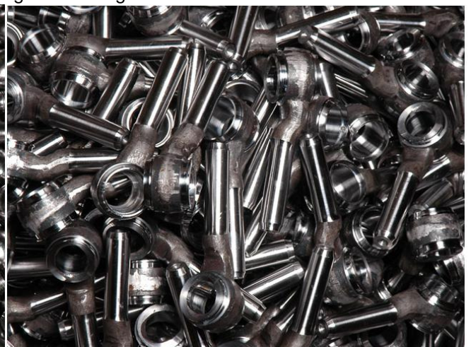
Bearbeitete Rohlinge, nach Stichprobenprüfung wird die Gewinde geschnitten
