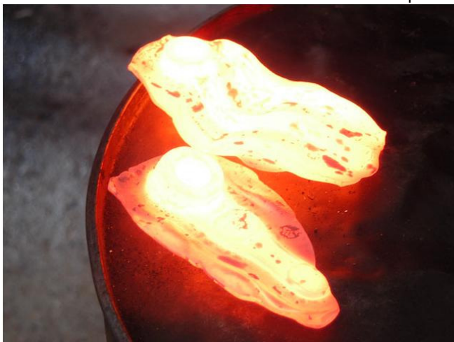
Geglüht- und geschmiedete Rohlinge
