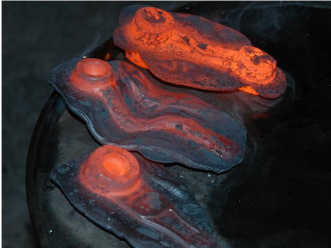
Diverse geglühte- und geschmiedete Rohlinge
