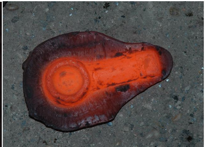
Geglüht- und geschmiedete Rohlinge
