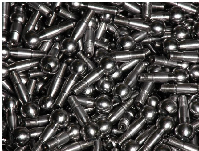
Bearbeitete Rohlinge, nach Stichprobenprüfung wird die Gewinde geschnitten
