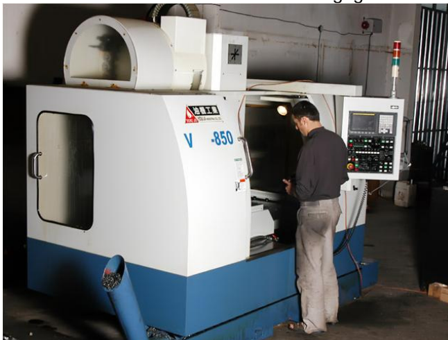
CNC Bearbeitung der Rohlinge
