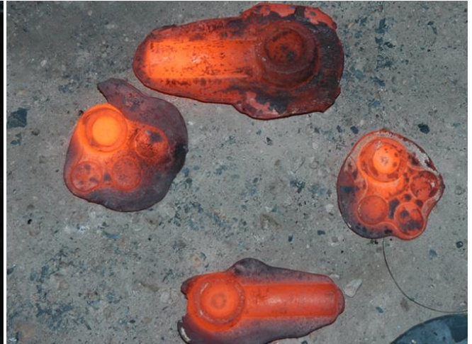
Diverse geglühte- und geschmiedete Rohlinge
